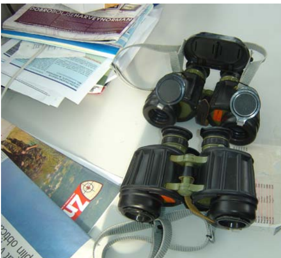
Slika 12: Daljnogleda z oznakami, narejenimi s tritijem aktivnosti 37 GBq, kar presega nivo izvzetja 1 GBq
