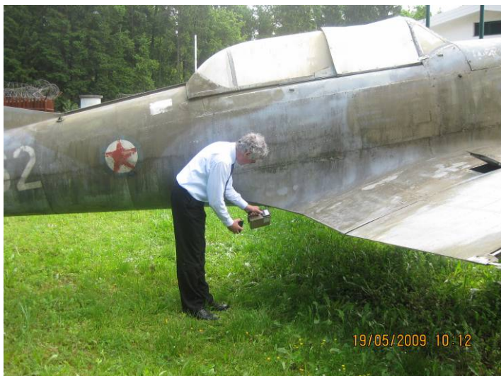
Slika 13: Letalo, v katerem je radioaktivni višinomer nad mejo izvzetja
